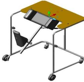
Para el modelo inicial mostrado en la figura 1 se determinaron el factor de seguridad, los desplazamientos máximos, así como el comportamiento a la fatiga, para distintas inclinaciones del asiento. Ver Figs. 2 y 3.
